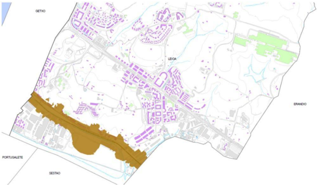
Figura 12. Huella de la servidumbre acústica del Metro de Bilbao. Fuente: Mapa de Ruido del término municipal de Leioa (2016).
